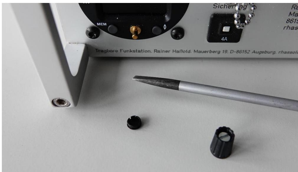
Bei funke ATR833S Funkgeräten ziehen Sie die Folie vorsichtig über die beiden Drehknöpfe. Die Folie dehnt sich und zieht sich um die dünnen Wellen unter den Knöpfen zusammen. Schieben sie die Folie am Umfang des Knopfes vorsichtig mit einem stumpfen Gegenstand nach unten, so dass sie unter den unteren Rand des Drehknopfes schlüpft.
