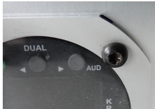
Stecken Sie eine Schraube durch eine Bohrung des Aluminiumringes, dann durch die korrespondierende Öffnung der Folie und drehen sie die Schraube vorsichtig in die entsprechende Bohrung im Gehäuse in das eingebaute Gerät.
